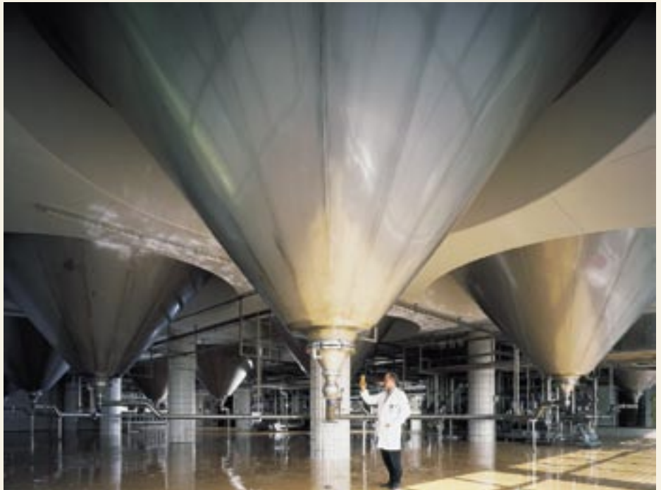
Die Gär- und Lagerkeller: Nach dem Kochen wird die heiße Würze abgekühlt und in die Gärkeller gepumpt. (Quelle Krombacher)
